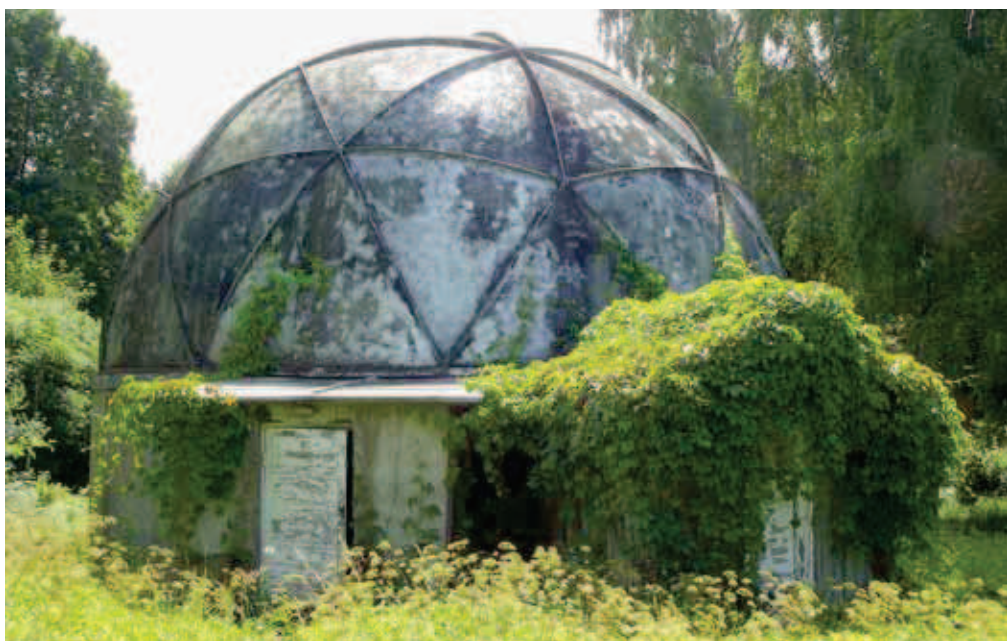
5P jeb Pirmais Putnu Pētniecības Planetārijs Pasaulē. Kupols veidots no stiklaplasta trijstūrveida plāksnēm, kas nokrāsotas ar alumīnija krāsu. Projektētājs un būvnieks – Viesturs Klimpiņš.
